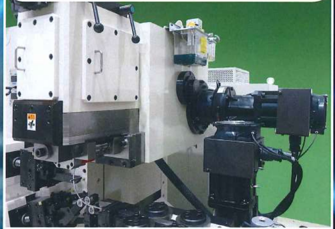
耐久性に優れたプレス切断機構 Strong Press Cutting Structure
