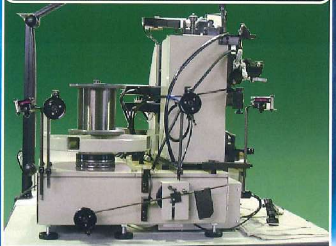
線台との一体設計 / Integrated Design with Pay-off Reel
